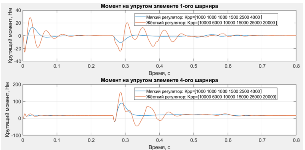
Рисунок 31 – Момент на упругом элементе 1-ого и 4-ого шарнира при соударении в момент времени t=0,3 с
