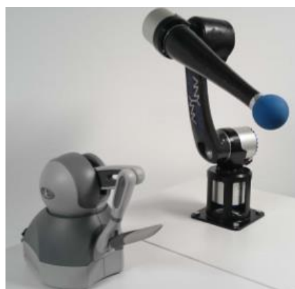
Рисунок 8 – Манипулятор ANYpulator с шарнирами ANYdrive, разработанный в ETH Zurich [7]
