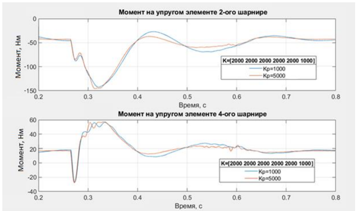
Рисунок 55 – Момент на упругом элементе 2-ого и 4-ого шарнира при соударении в момент времени t=0,3 с при средней жёсткости
