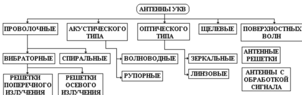
Рисунок 2 – Классификация антенн ультракоротких волн [5]
