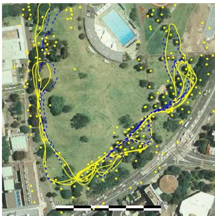
Рисунок 3.10 – FastSLAM в сравнении с GPS
