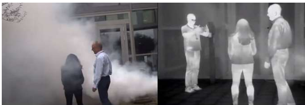
Рисунок 3.1 – Сравнение работы простой камеры и камеры ночного видения при задымленности
