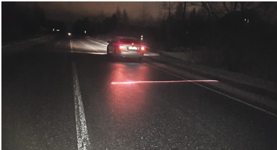
Рисунок 3.4 - Принцип работы лазерного стоп-сигнала от противотуманных фонарей
