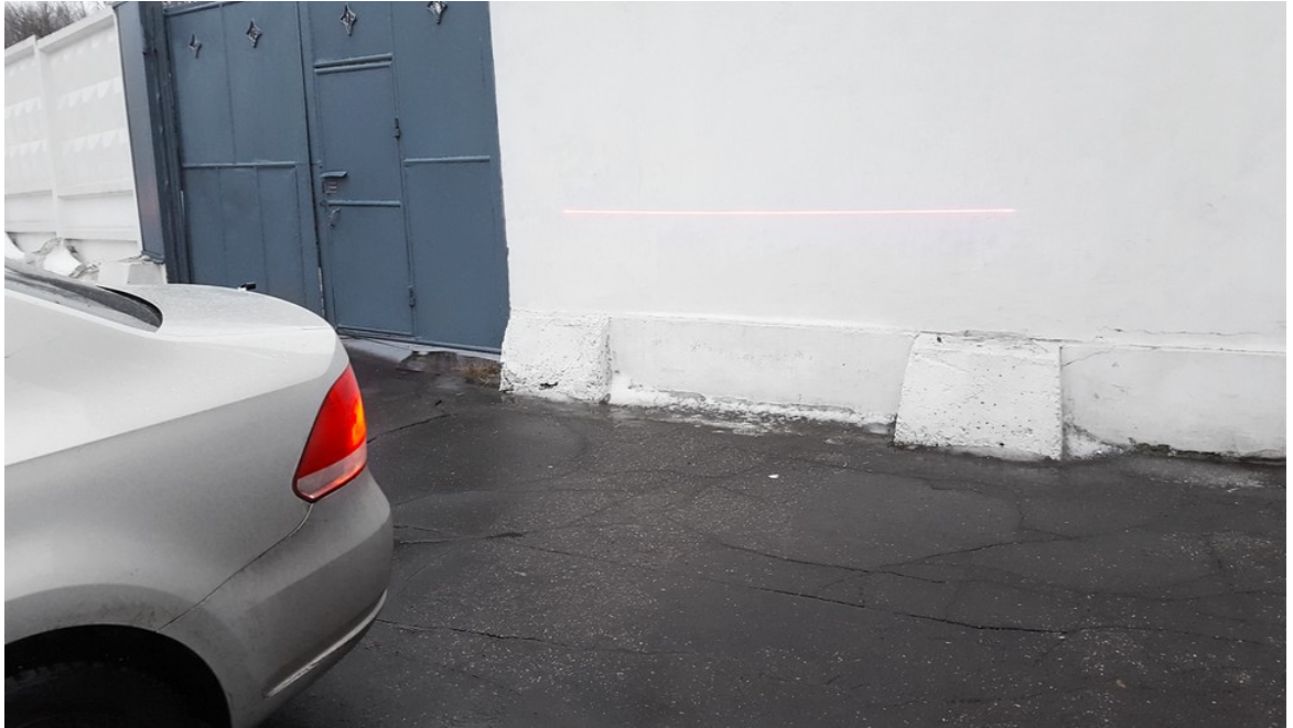
Рисунок 3.5 - Лазерный стоп-сигнал как вспомогательное устройство при парковке
