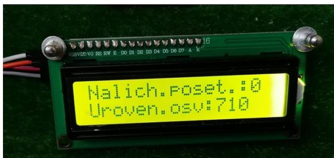
Рисунок 49 – Отображение значений входных переменных на LCD-дисплее
