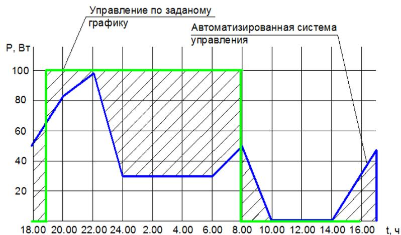
Рисунок 50 – Разница в графиках нагрузки в зимний, осенний, весенний периоды
