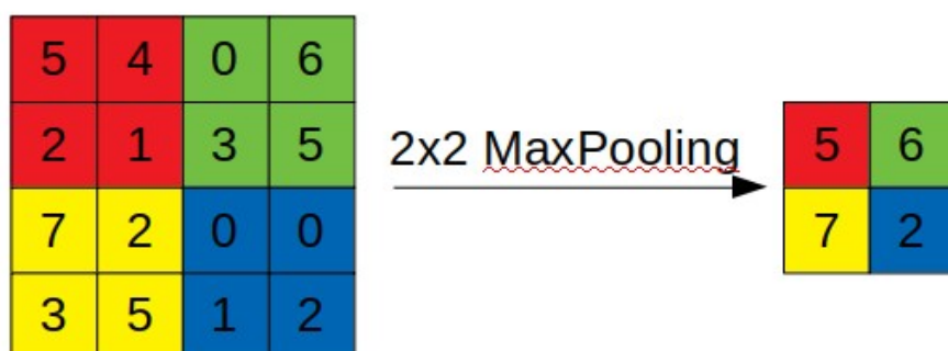
Рис.2.1.4: операция MaxPooling с ядром 2x2.
