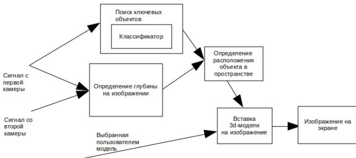
Рис. 3.1.1: схема взаимодействия модулей комплекса
