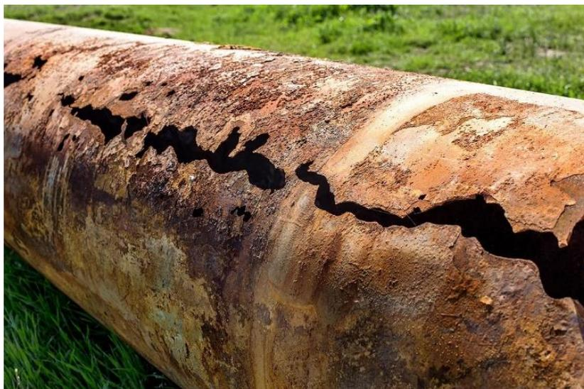
Рис.1.2. Коррозия на трубопроводе
