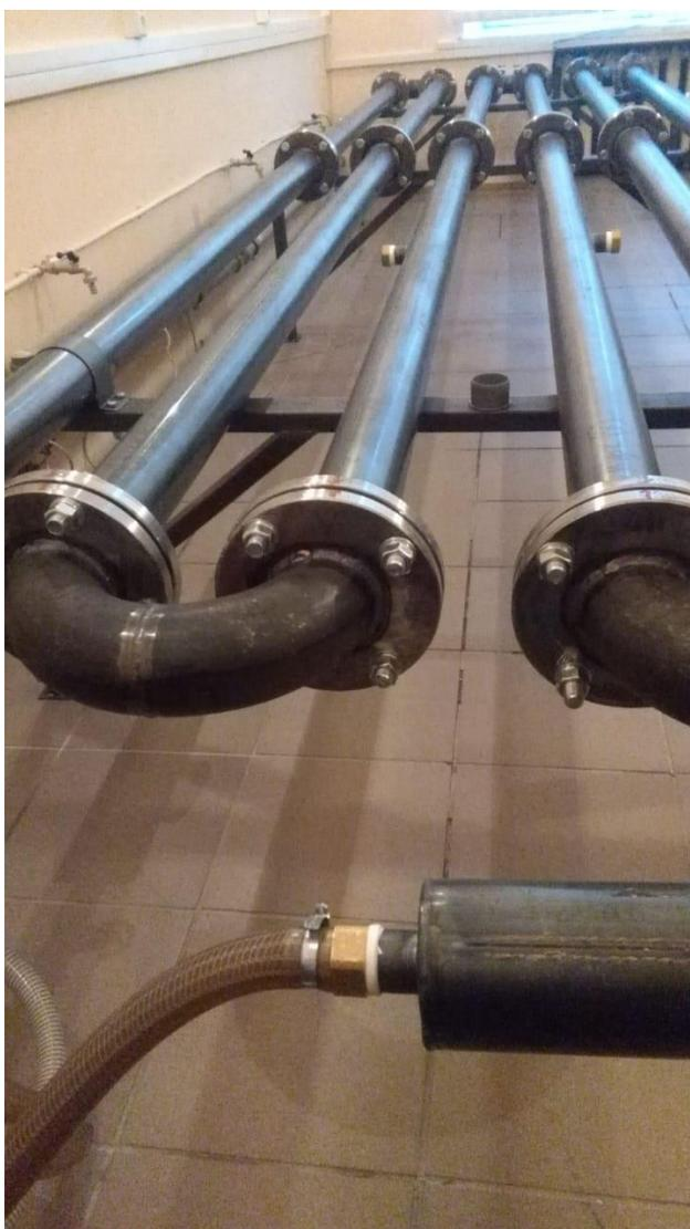
Рис.5.1 Натурный макет трубопровода
