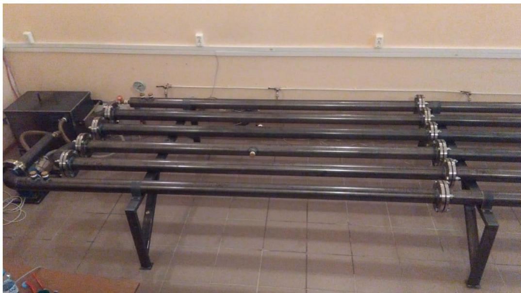
Рис.5.3. Установка натурального макета трубопровода в лаборатории
