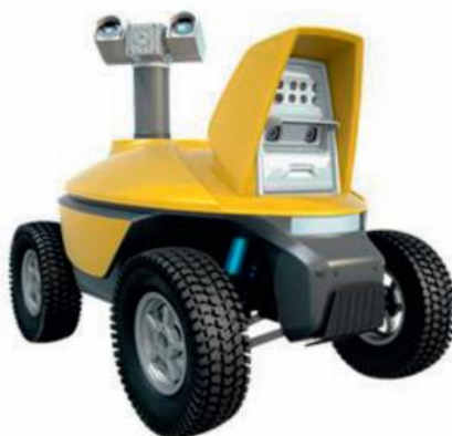
Рисунок 4 - Роботизированное средство для мониторинга биологических объектов в садоводстве
