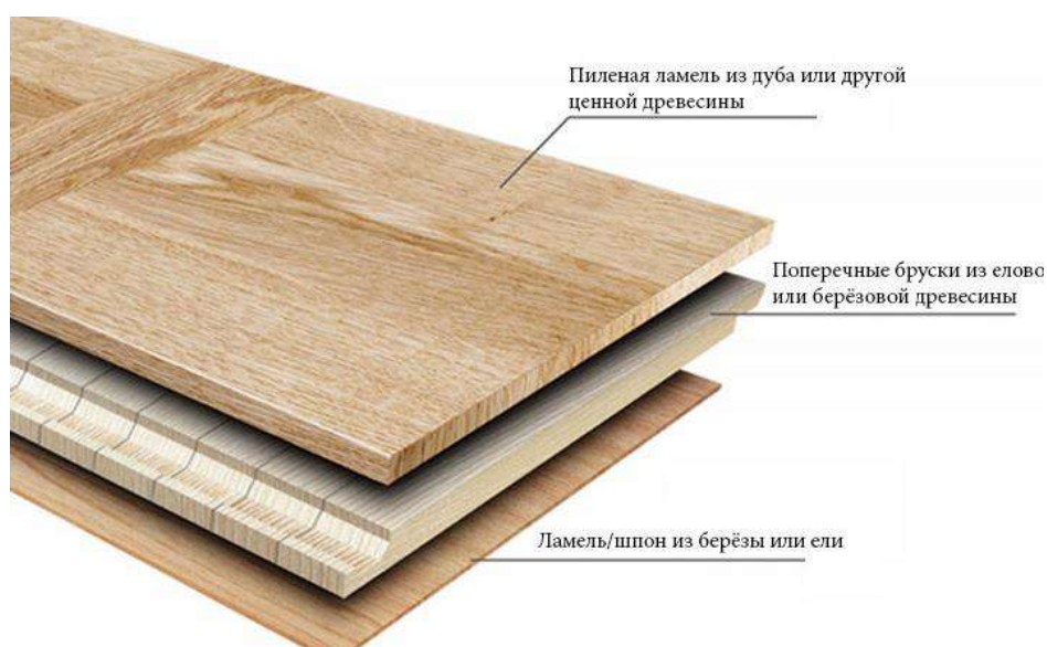
Рисунок 10 – Конструкция паркетной доски.
