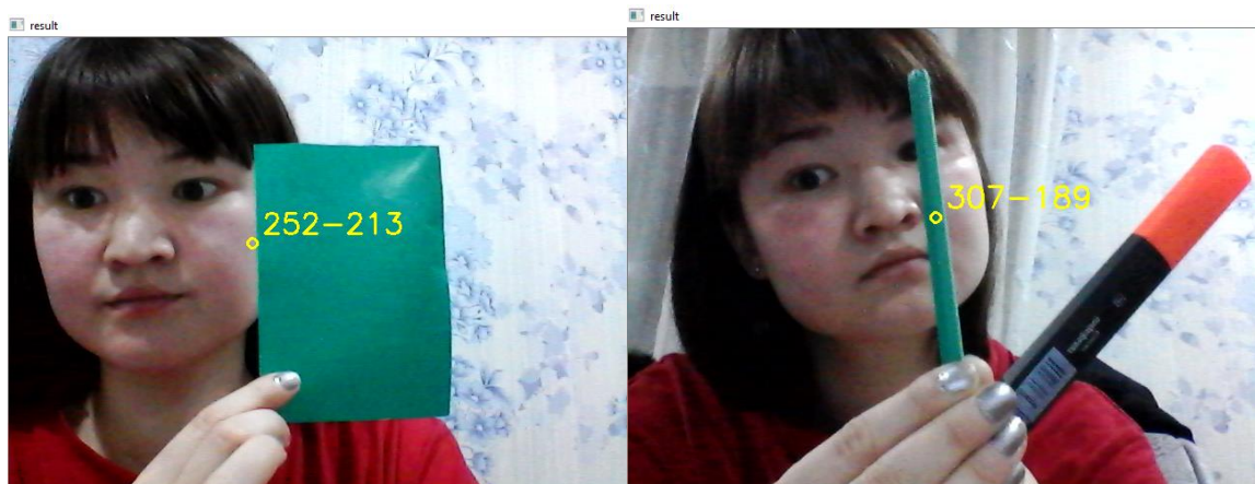
Рисунок 34 – Поиск цветового пятна и вывод координат
