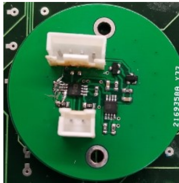
Рисунок 7.1 – Печатный узел индукционного датчика
