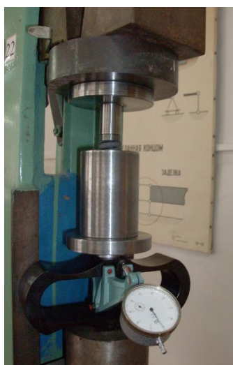
Рисунок 2.1 — Заневоливание пружины гидрозамка
