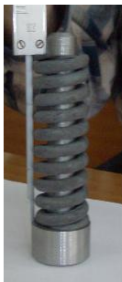
Рисунок 2.2— Пружина после заневоливания
