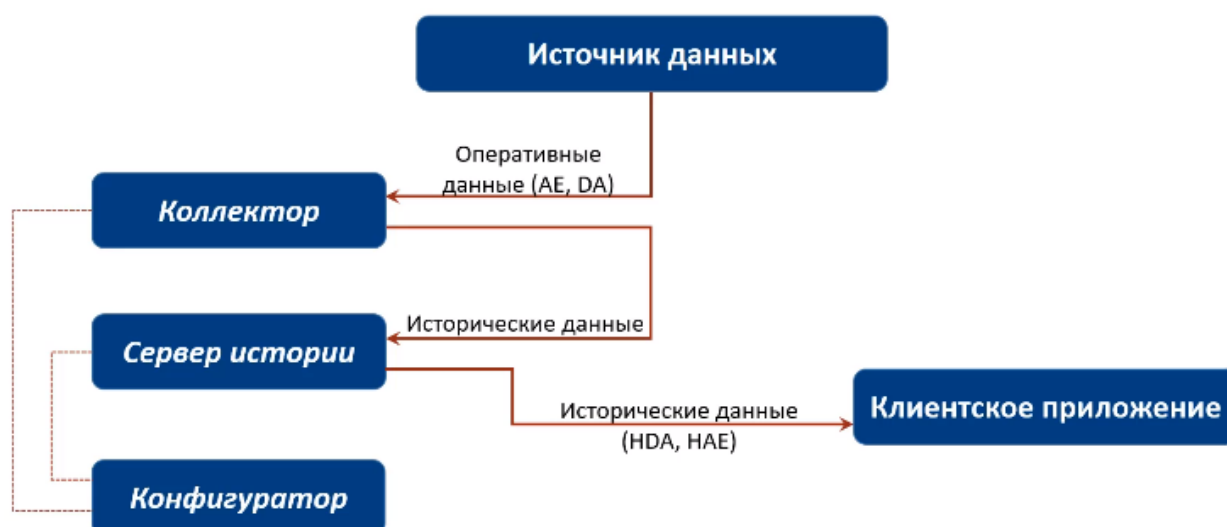
Рисунок 3.31 – Схема передачи данных
