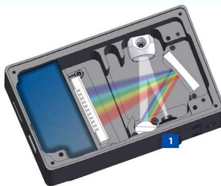
Рисунок 2.1 – Схема спектрометра с обозначением входной щели
