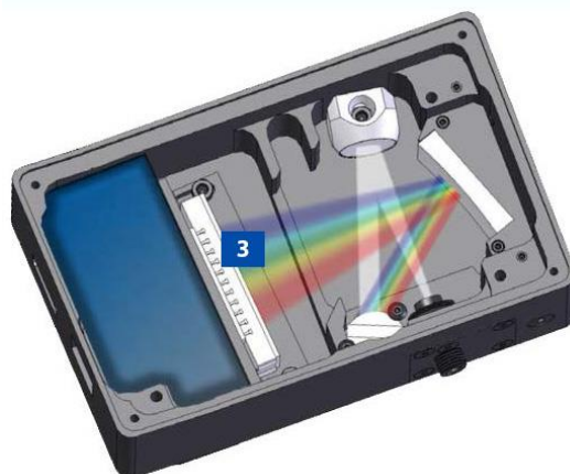
Рисунок 2.3 – Схема спектрометра с обозначением детектора
