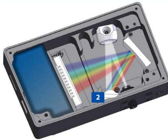
Рисунок 2.2 – Схема спектрометра с обозначением дифракционной решетки
