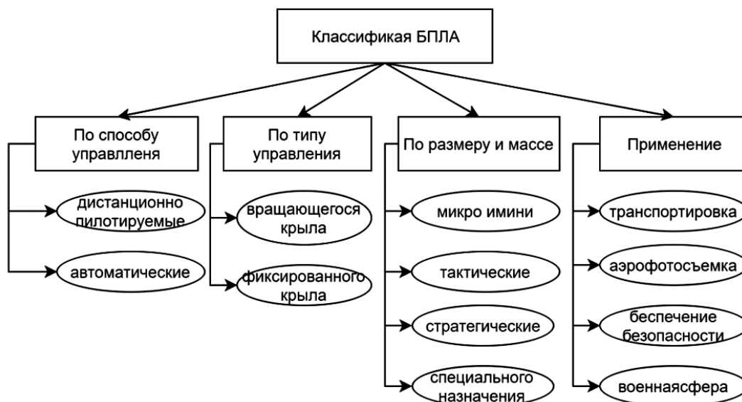
Рисунок 1.1 – Классификация беспилотных летательных аппаратов
