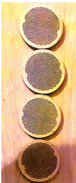
Рисунок 70 – Образец ЧЭ с перфорированными электродами
