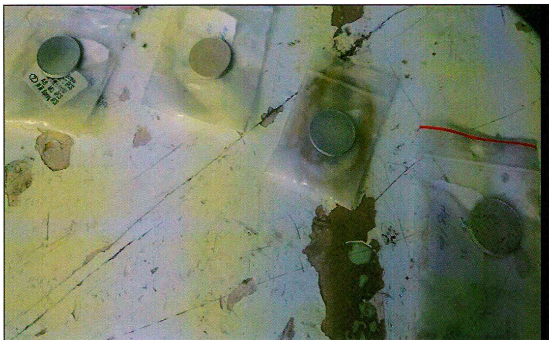
Рисунок 54 – Отпрессованные и обожжённые образцы керамики с различными присадками
