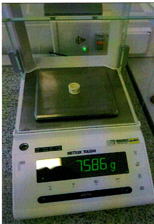
Рисунок 48 – Взвешивание образцов (до выдержки в кислотной среде)
