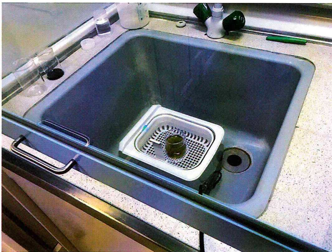
Рисунок 57 – Вымывание образцов в ультразвуковой ванне в кислоте
