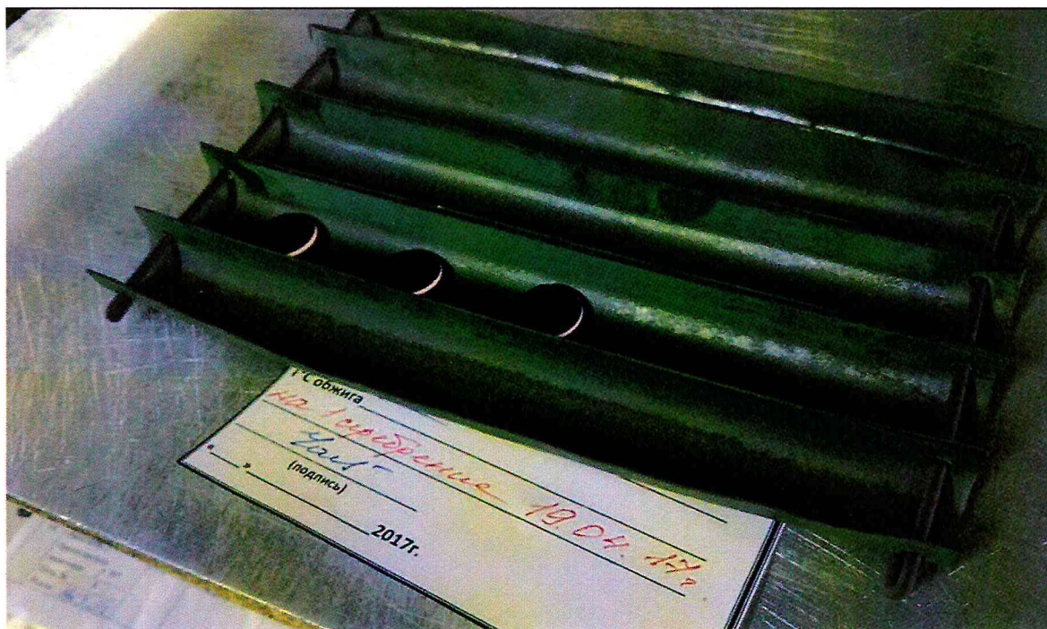
Рисунок 68 – Процесс нанесения первого слоя серебра толщиной 14 мкм (серебро нанесено, образцы в форме для обжига)
