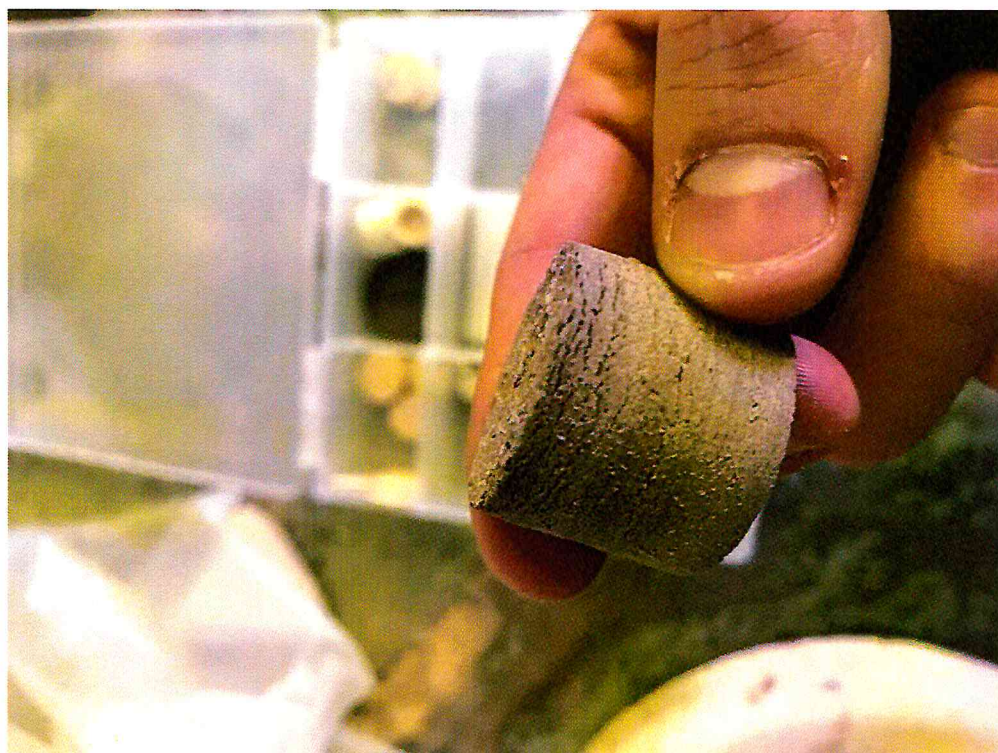
Рисунок 55 – Пример забракованного керамического материала не прошедшего испытания на механическую прочность.
