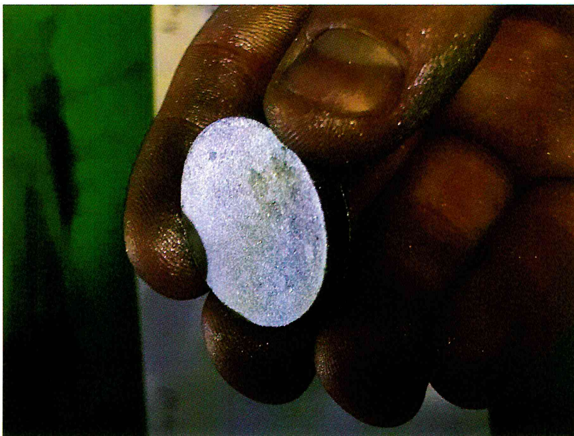
Рисунок 56 – Пример проведения монолитной опрессовки заготовки сорбирующего слоя.
