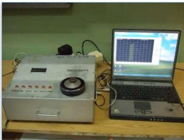
**Рис. 2.1 Прибор для регистрации ССФЭ - хемилуминометр Биотокс-7А 2М**
