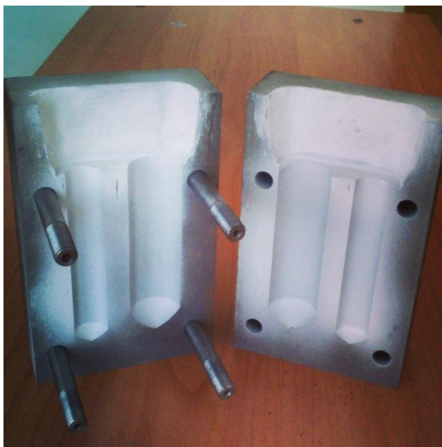
Рисунок 20 - Общий вид кокильной оснастки для получения образцов литых алюмоматричных композитов
