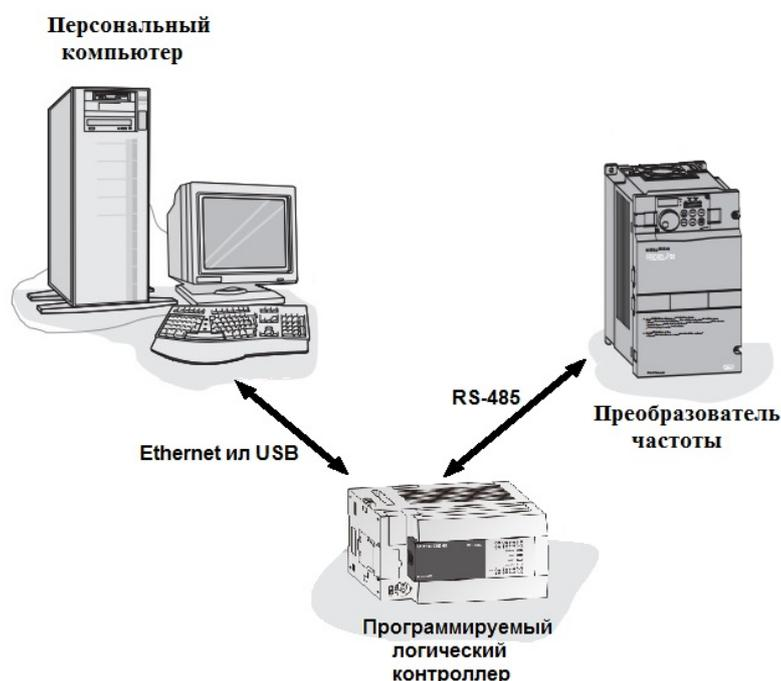
Рисунок 1.6 – Структура стенда с использованием ПЛК
