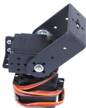
Рисунок 2.11 – Конструкция, обеспечивающая вращение кронштейна
