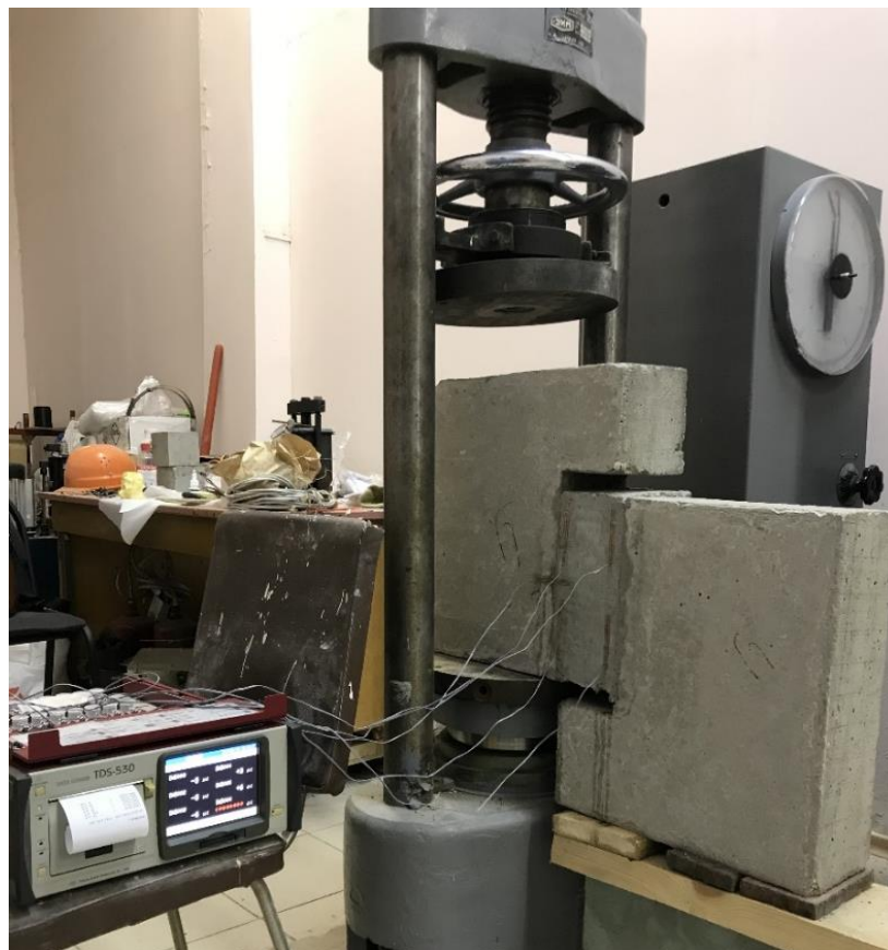
Рис. 3.6 Общий вид экспериментальной установки с монтированным образцом вертикального шпоночного стыка и подключенным многоканальным измерительным комплексом TDS-530.
