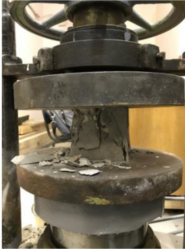
Рис. 3.5 Определение прочности бетона шва омоноличивания и бетона стеновой панели.
