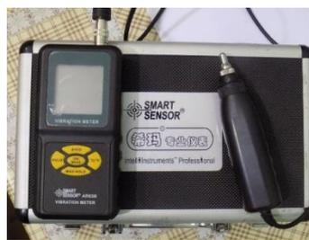
Рисунок 2.4 – Портативный виброметр Smart Sensor AR63B
