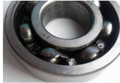
Рисунок 2.12 – Дефект сепаратора
