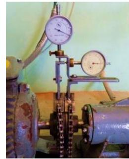
Рисунок 2.6 – Центровочное устройство
