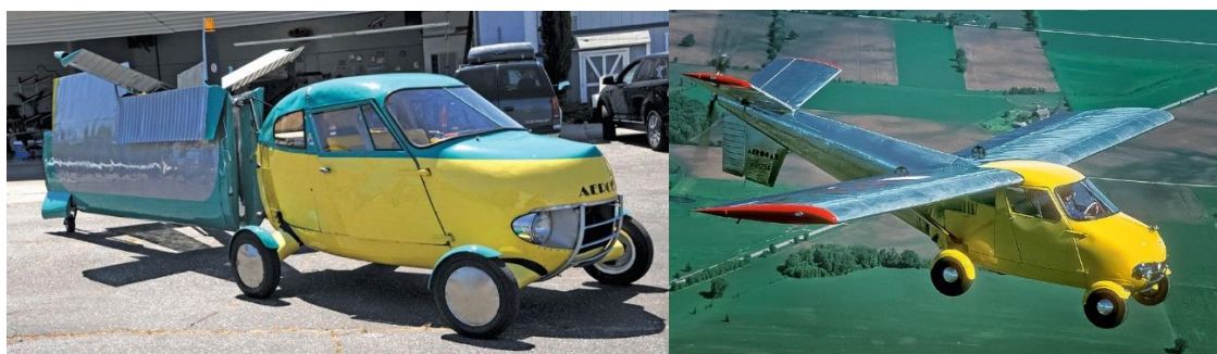
Рисунок 1.8 – Аэрокар М. Тейлора с самолетным комплектом (слева), аэрокар М. Тейлора в полёте (справа)
