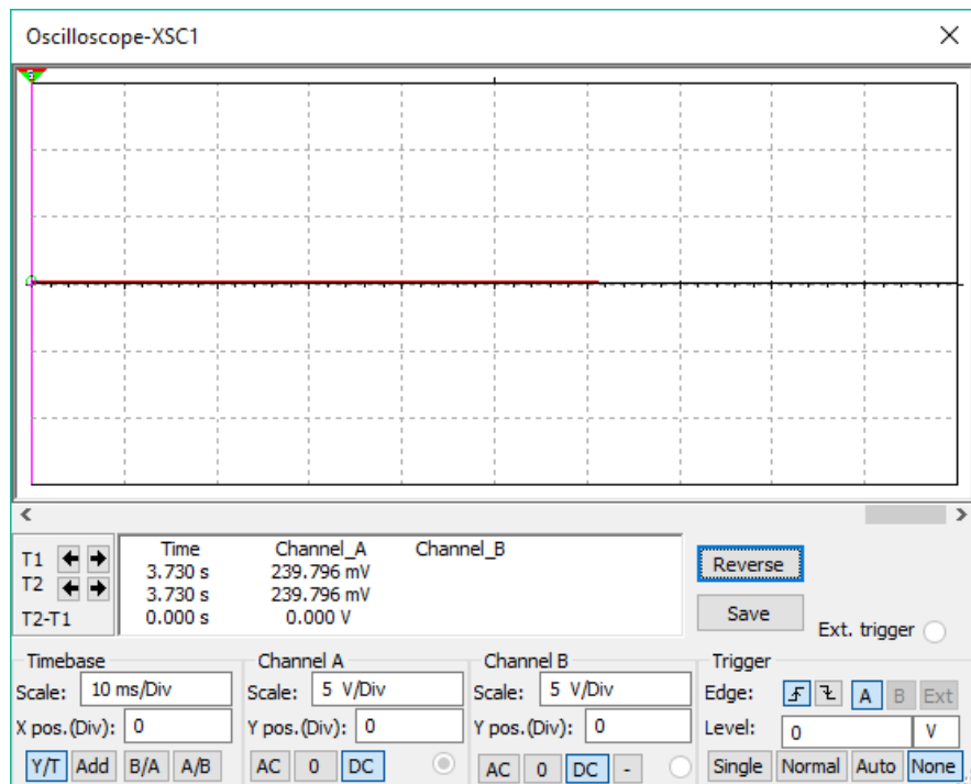
Рисунок 2.4 – Наличие сигнала после разбалансировки моста
