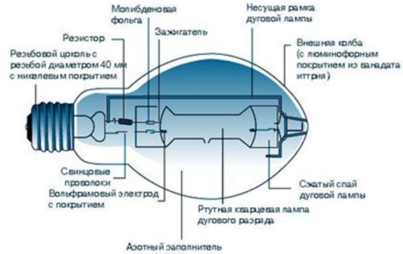
Рисунок 5-Устройство лампы ДРЛ
