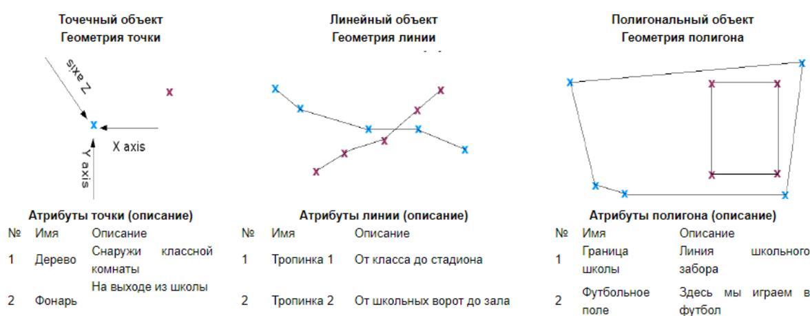
Рисунок 4 – Геометрия векторного объекта в графическом представлении
