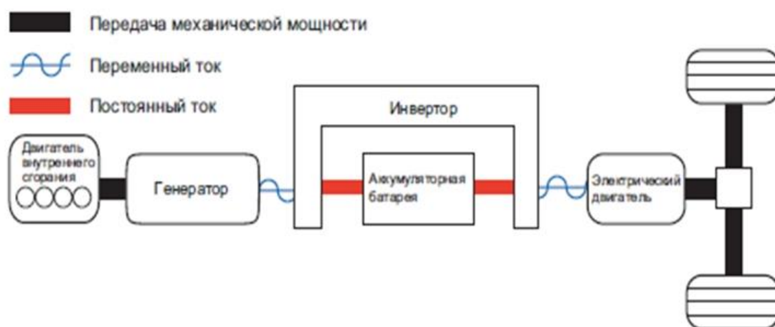
Рисунок 2.2 – Общая схема гибридного автомобиля
