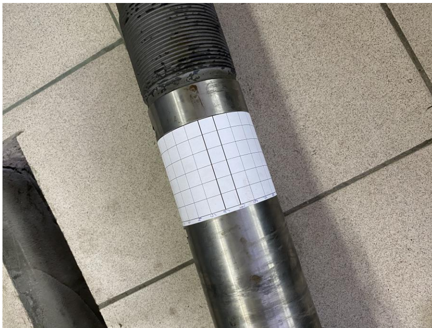
Рисунок 4.10 – Обрзоец после лазерной закалки, с нанесенной сеткой для измерений
