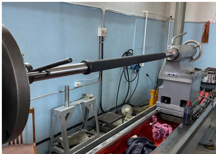
Рисунок 2.1 – Деталь перед лазерной закалкой с нанесенным светопоглощающим покрытием
