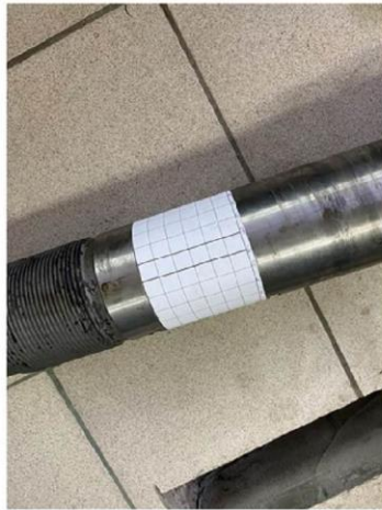
Рисунок 1 - Образец после лазерной закалки, с нанесенной сеткой для измерений
