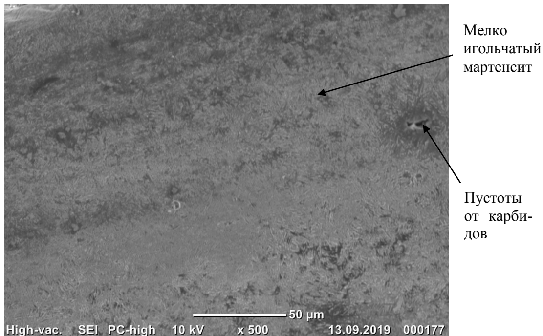
Рисунок 3.17 – Микроструктура стали 5ХНМ после лазерной закалки с предварительной термической обработкой при увеличении x500
