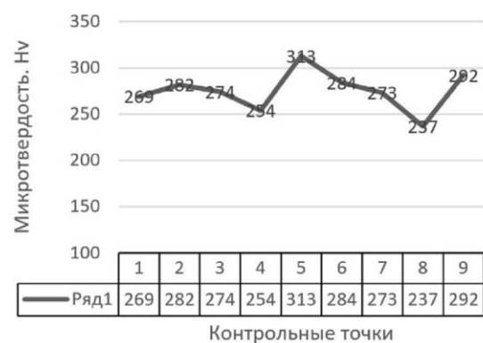
а - лазерная сварка с использованием присадочной проволоки; б - контактная Рисунок 1- Сравнительные значения распределения микротвердости сварного шва, зоны термического влияния и основного металла для различных способов лазерной сварки на мощности 1,2 кВт
