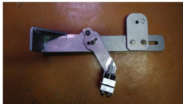
Рисунок 2 - Кронштейн крепления к роботу-манипулятору автомата подачи присадочного материала
