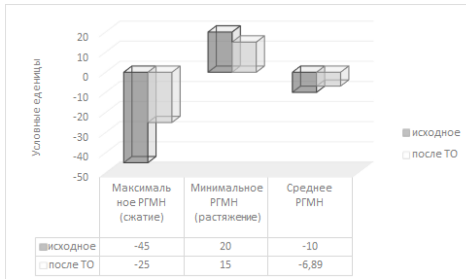
Рисунок 4.9 – Гистограмма сравнения напряжений сварочной конструкции после сварки и после проведения термической обработки сварного соединения
