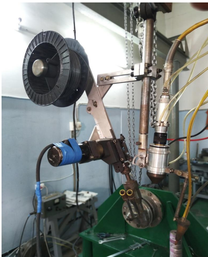
Рисунок 2.8 – Смонтированное сварочное приспособление
