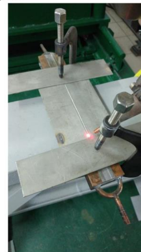
Рисунок 5 - Образец 2,0 мм. 12X18H10T закреплён на шине и подготовлен под сварку
