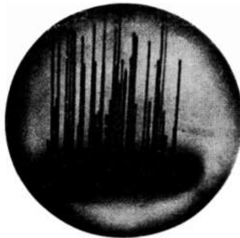
Рис. 2. Осциллографическая картина барьерного разряда. Длина разрядного промежутка 0,9 мм, напряжение 10,5 кВ.
