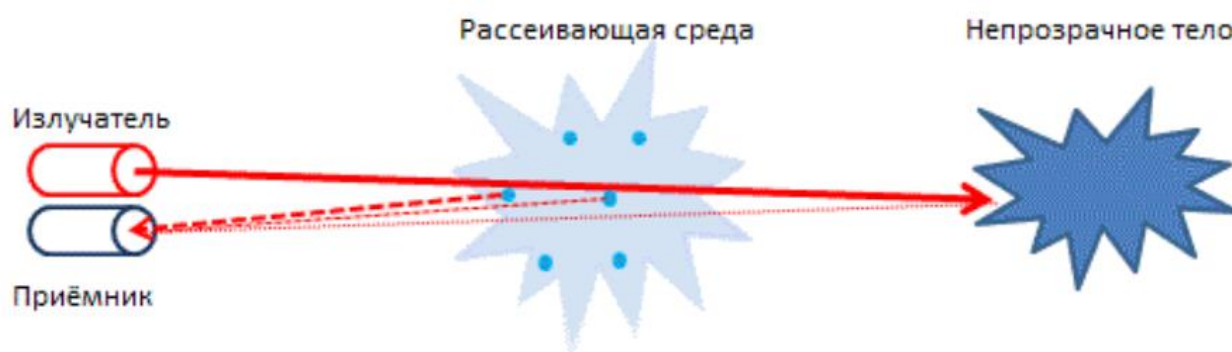
Рисунок 17 – Принцип лазерного измерения расстояния
