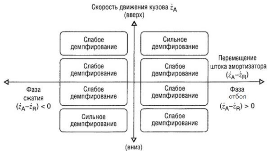
Рисунок 8 – Схема управления для метода Skyhook
