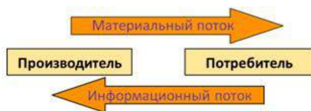
Рисунок 2- Управление производством по принципу супермаркета «Канбан»
