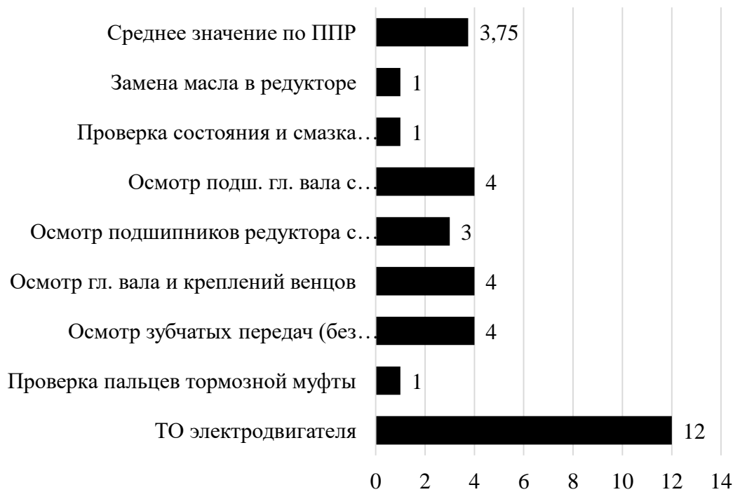
Рисунок 31 - Структура работ ППР и сокращение в периодичности ремонтов по техническому состоянию.
