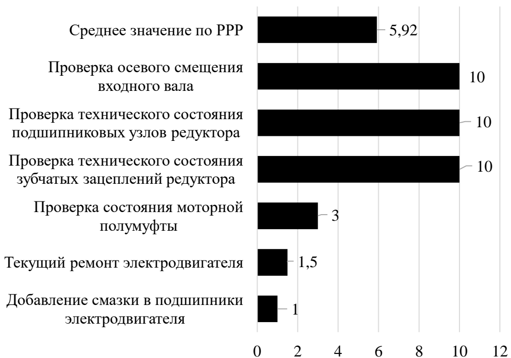
Рисунок 32 - Структура работ РРР и сокращение в периодичности ремонтов по техническому состоянию
