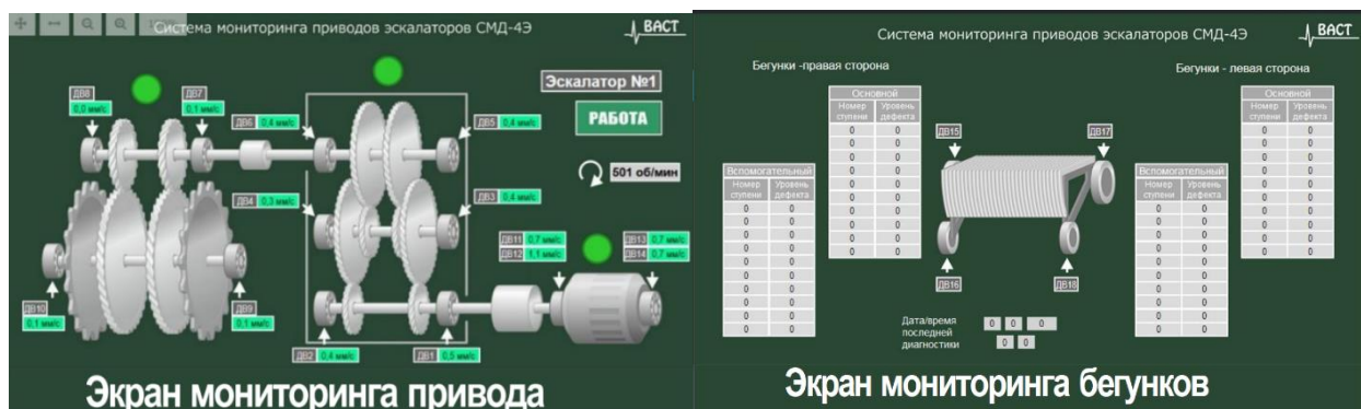
Рисунок 34 - Пример ПО и экранов мониторинга привода и бегунков от компании ООО «Ассоциация ВАСТ»
