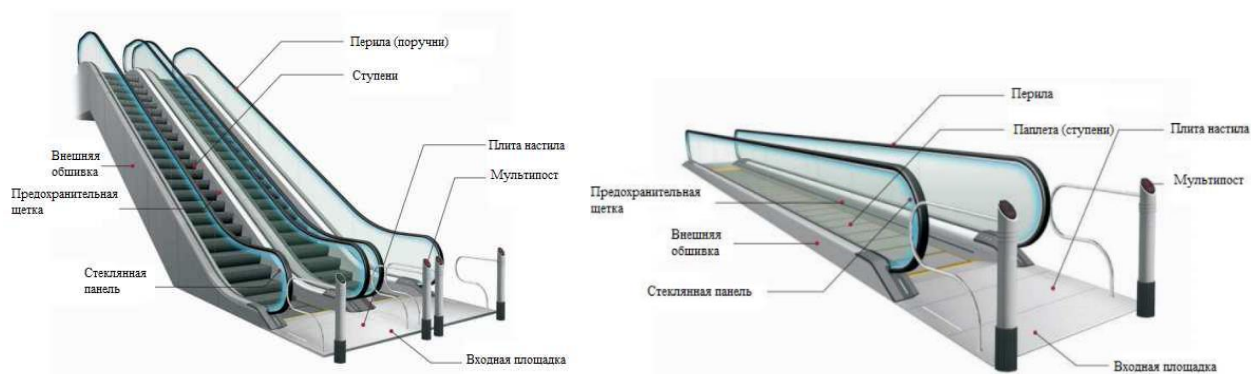
Рисунок 3 – Общий вид эскалатора и траволатора
