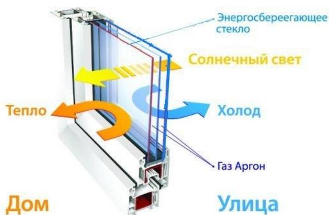
Рис.1.4 Энергосберегающий стеклопакет, заполненный аргоном [13]
