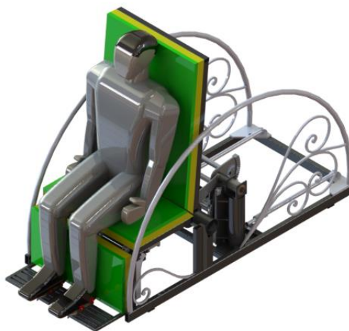
Рисунок 47 – Кровать для реабилитации в положении сидя
