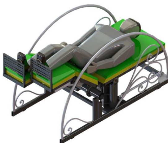
Рисунок 48 – Кровать для реабилитации в положении тренажера ног
