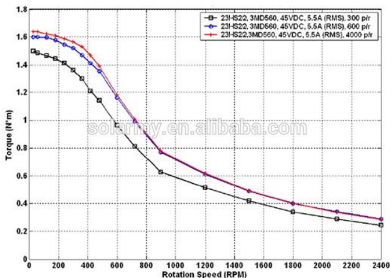
Рисунок 58 – Кривая характеристик шагового двигателя
