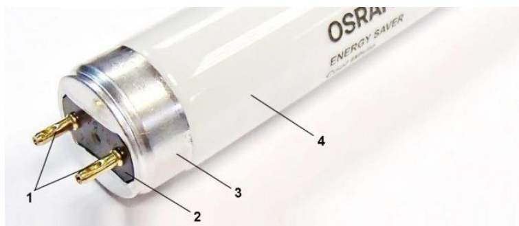
Рисунок 3.7 – Внешний вид и конструкция цоколя G13. 1 – токоподводящие штырьки, 2 – держатель, 3 – стакан, 4 – колба лампы.
