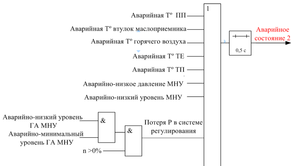
Рисунок 10- Алгоритм формирования аварийного состояния 2
