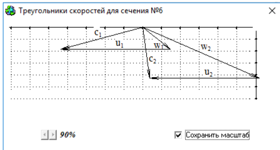
Рисунок 4 – Треугольники скоростей для среднего сечения
