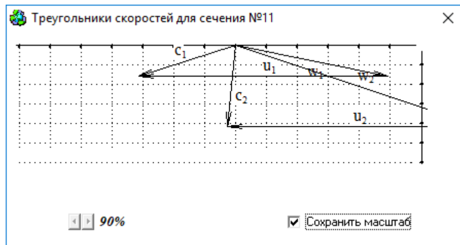
Рисунок 5 – Треугольники скоростей для периферийного сечения
