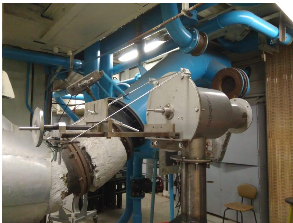
Рисунок 18 – Горизонтально расположенный регулирующий клапан на баке ресивере
