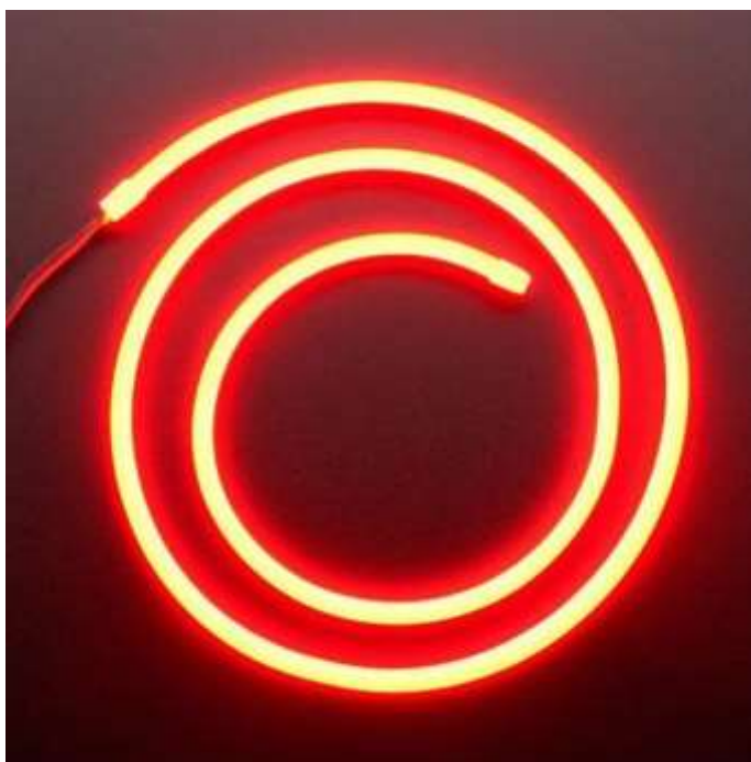
Рисунок 1 – Электролюминесцентный провод (гибкий неон)
