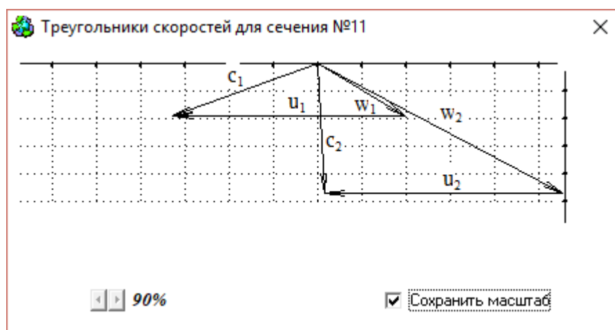
Рисунок 4.5. Треугольники скоростей для периферийного сечения
