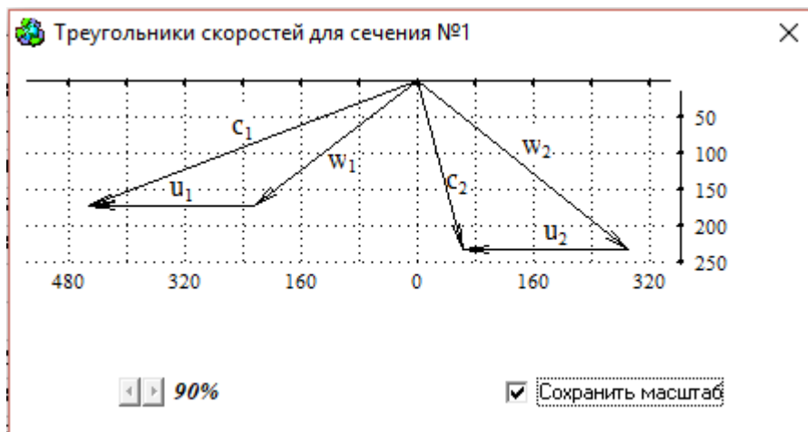
Рисунок 4.3. Треугольники скоростей для корневого сечения
