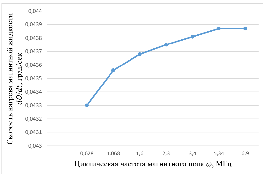
Рисунок 3.15 - График зависимости скорости нагрева магнитной жидкости от циклической частоты магнитного поля.
