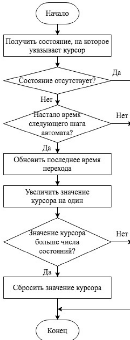
Рисунок 37. Схема алгоритма переключения состояния конечного автомата.
