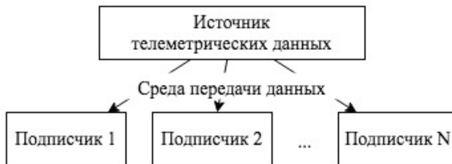
Рисунок 41. Схема передачи сообщений при дисциплине PUB/SUB.
