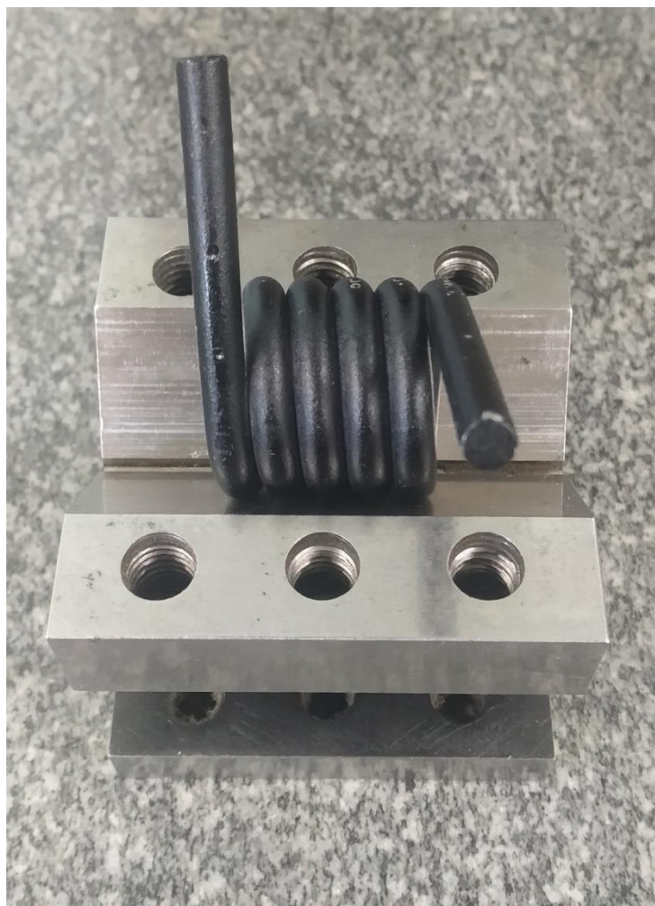
Рисунок 8 Измерение высоты навитой части пружины кручения в горизонтальном положении
