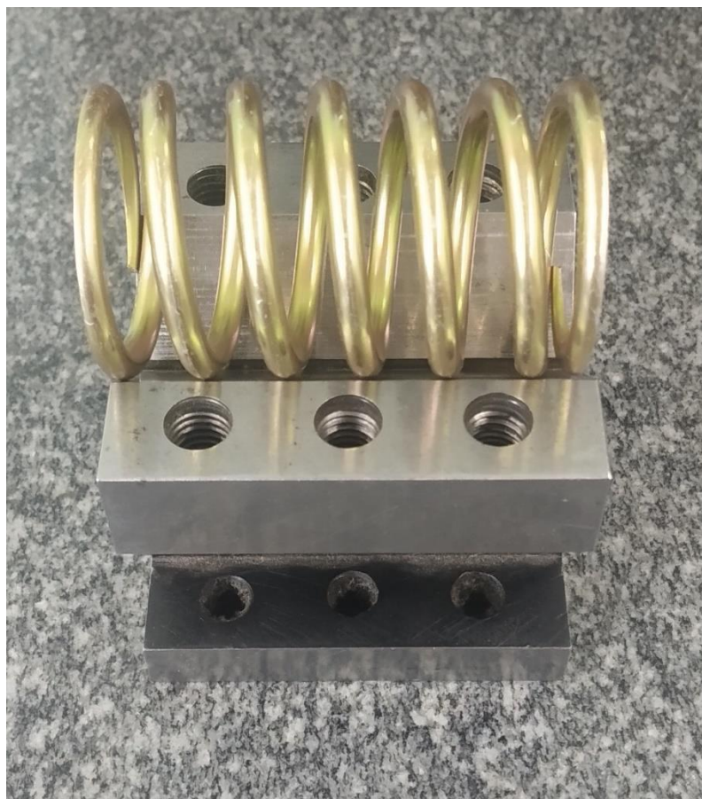
Рисунок 7 Измерение высоты (длины) навитой части пружины сжатия в горизонтальном положении
