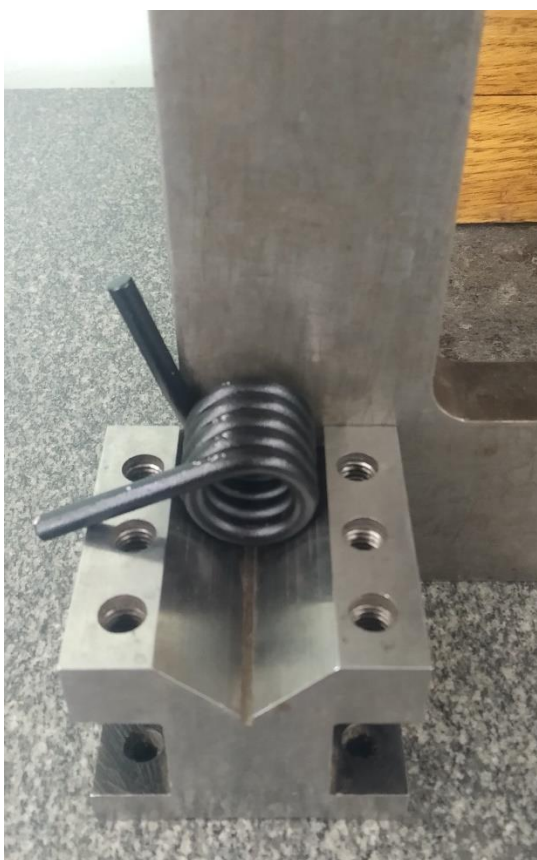
Рисунок 25. Установка пружины, с использованием приспособления
