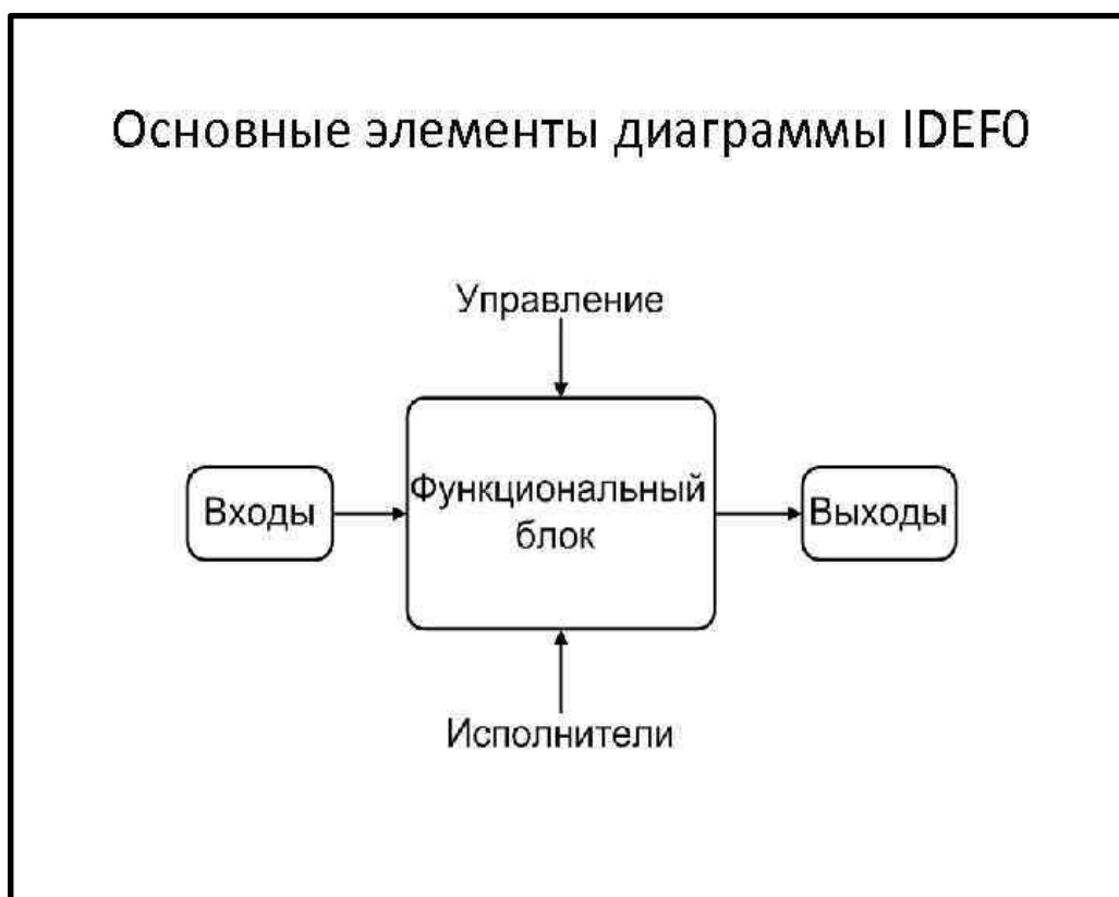
Рисунок 3.2 - Структура графической нотации IDEF0
