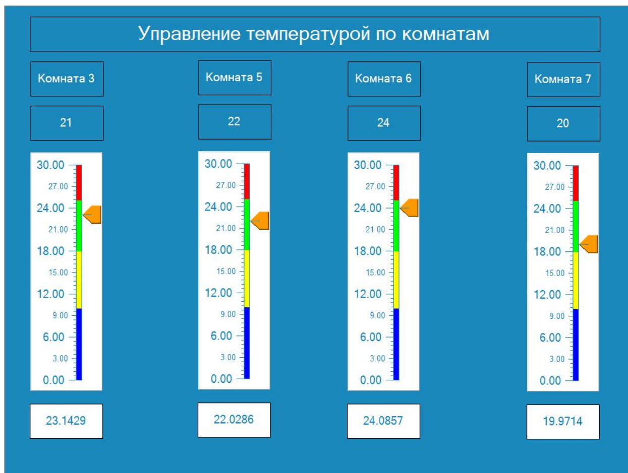
Рис 2.12 Окно визуализации процесса в SCADA Trace Mode
