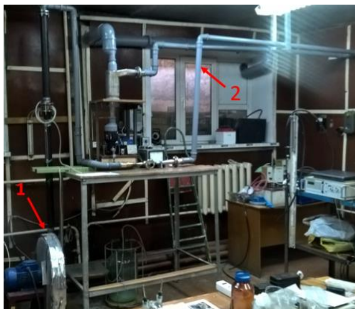
Рис. 4. Общий вид экспериментальной установки в потоке газо-воздушной среды 1 – дутьевой вентилятор; 2 – закольцованная система для рецикла золы.
