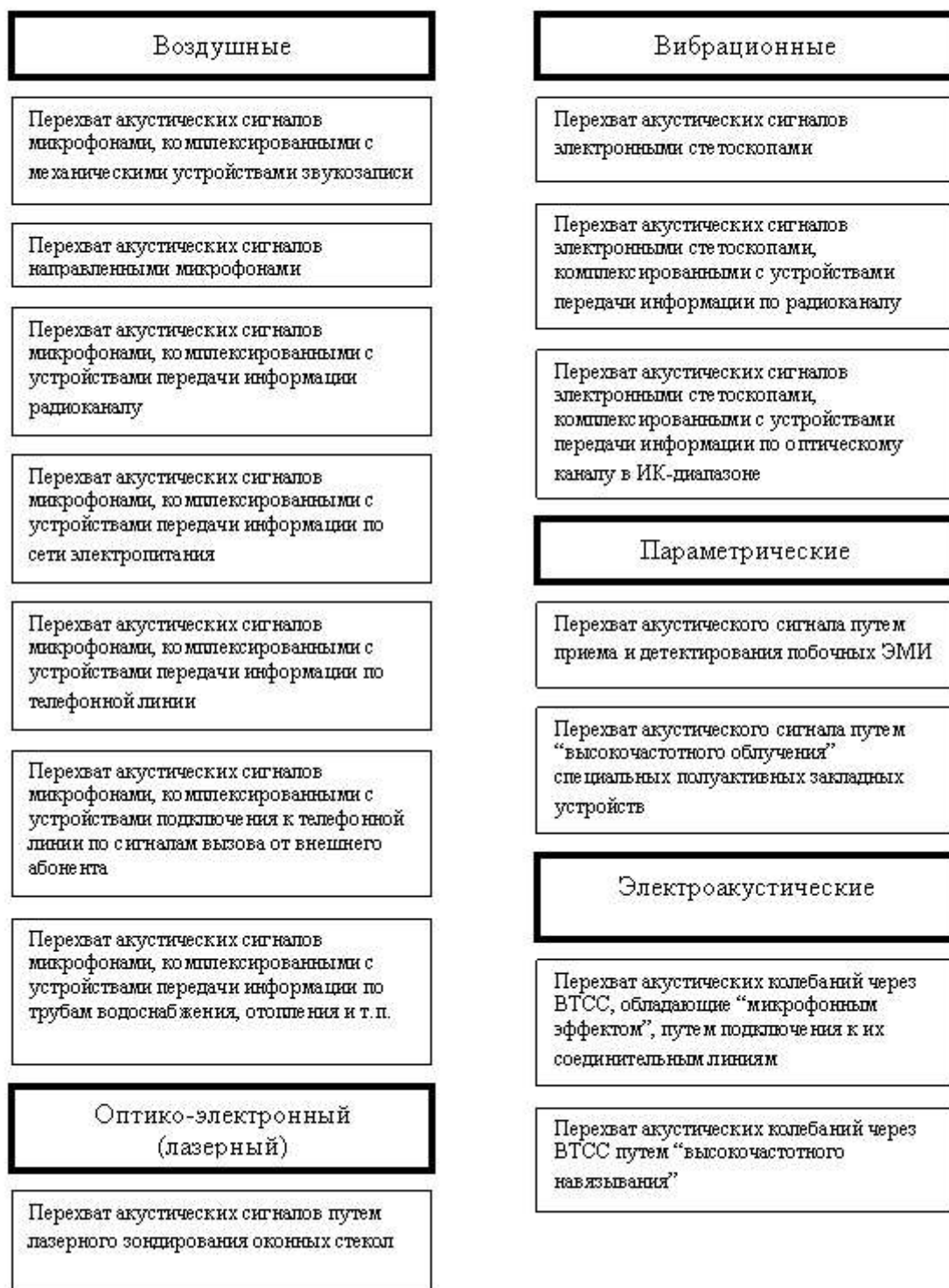
Рисунок 1.1- Классификация технических каналов утечки акустической информации.
