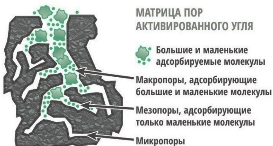
Рисунок 1.6 Матрица пор активированного угля
