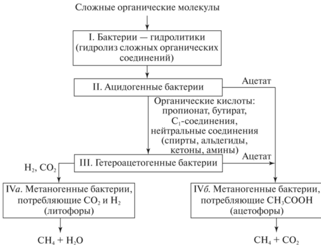
Рисунок 1.5 - Процесс анаэробного сбраживания
