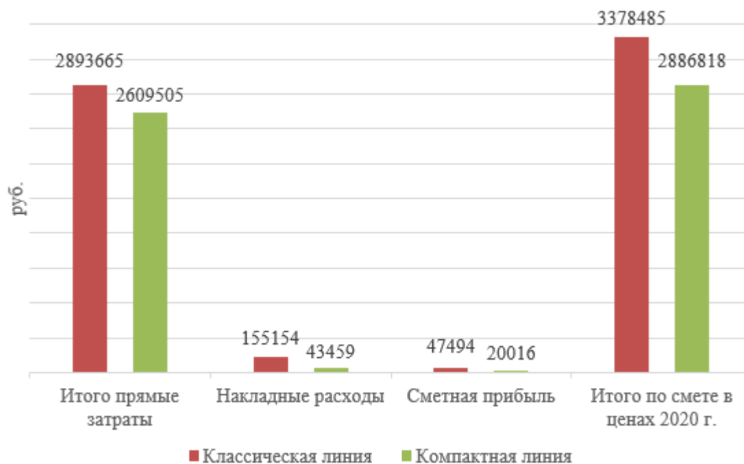
Рис. 3.3. Сметный расчет линий электропередач
