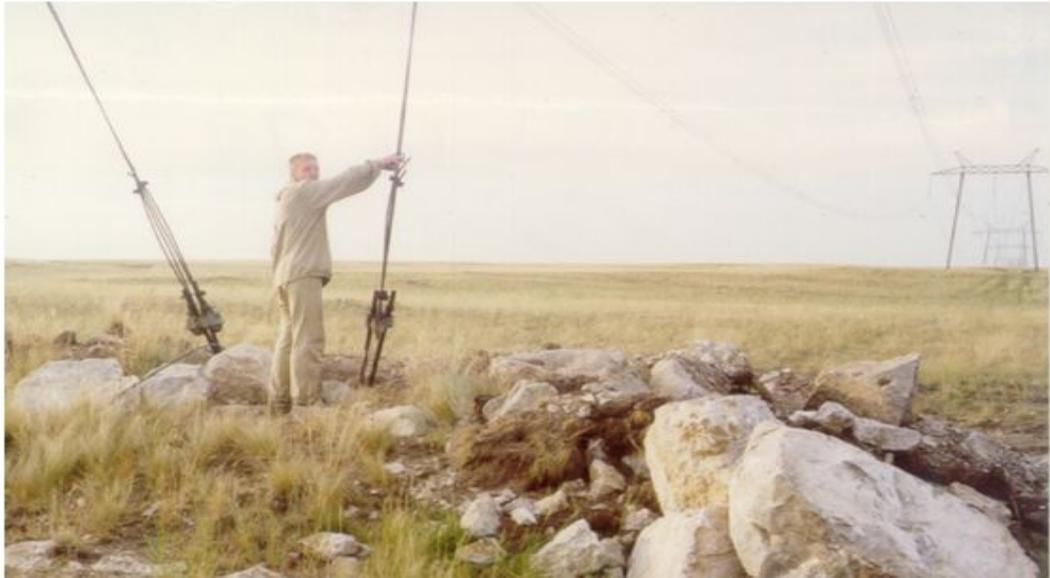
Рисунок 1.4 - Натурное измерение наведенных токов в оттяжках опоры ЛЭП
